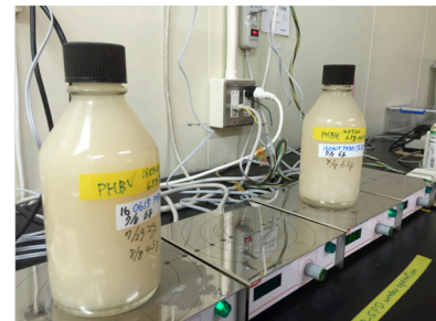
図 1.脱窒培養中の PHBH2 および PHBV2 リアクターの外観。
